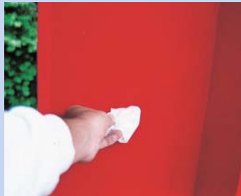
LUMIFLON™ ชั้นส่วน: ไม่มีการเกิดสีลอกเป็นผงขอสก
