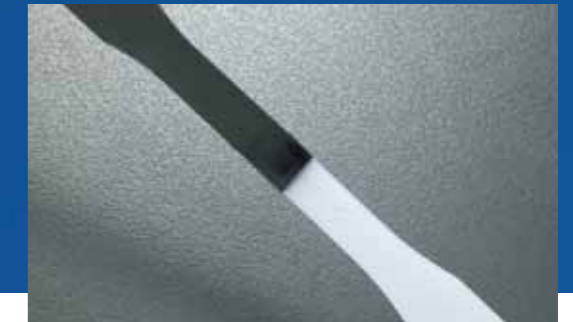
他素材との熔融接着を可能にしたフッ素樹脂
